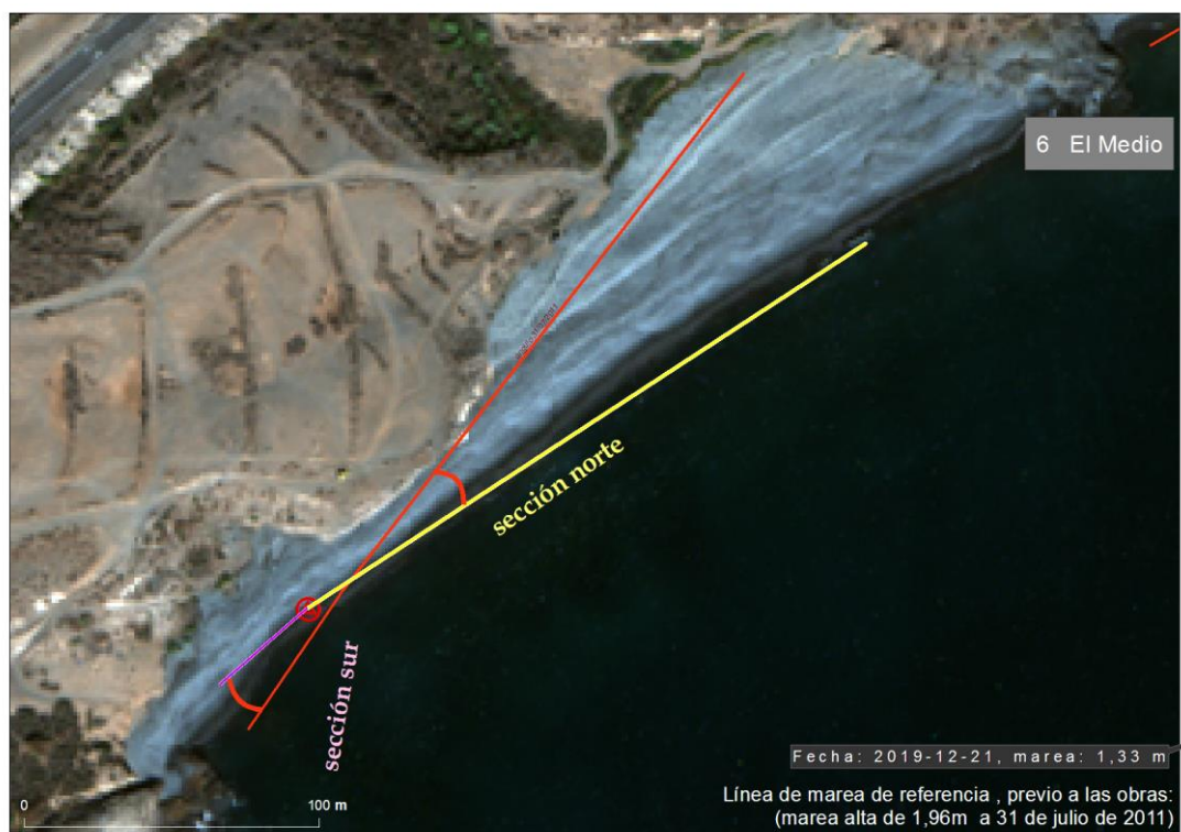
Figura 50 Nuevo modelo de playa con articulación para medir basculamiento. Playa de El Medio: 2011 (rojo) y 2019 (norte amarillo y sur púrpura). El ángulo a medir en rojo
