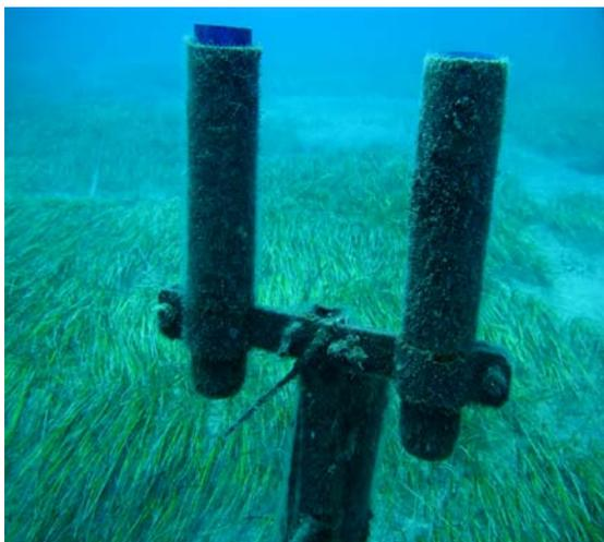
Figura 79. Captador de sedimento
