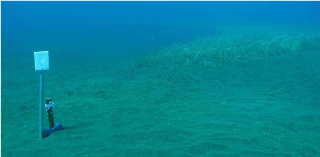
Figura 4. Estacado de prueba en el borde de una pradera: estaca de tubo galvanizado (2 cm  $\varnothing$  por 1 m long.) clavado hasta la mitad, con etiqueta vistosa de referencia.
