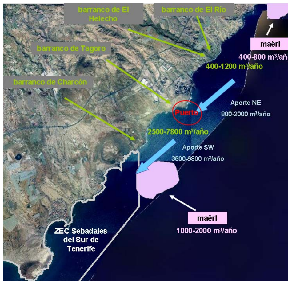
Figura 6. Esquema general del flujo de sedimentos aguas arriba y aguas abajo de la ubicación del futuro puerto de Granadilla.
